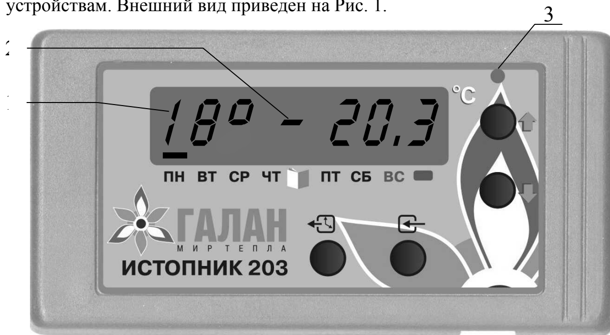
Рис.1. Внешний вид электронного комнатного программируемого индикатора температуры.
